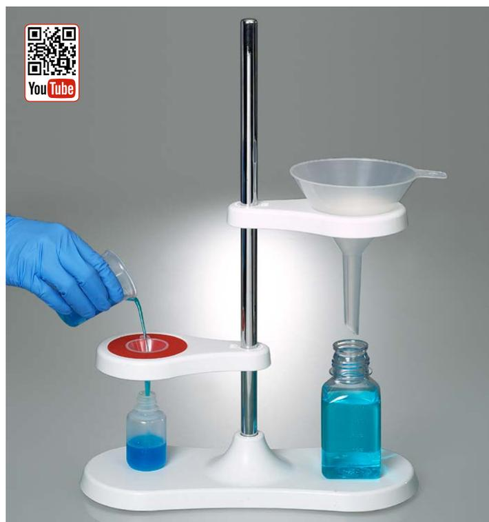
nécessaire, les supports d'entonnoir peuvent être réglés en hauteur de manière simple, flexible et à une main. Le support de laboratoire peut être adapté de manière flexible par des accessoires correspondants, par ex. avec des fixations d'entonnoir supplémentaires ou avec une fixation d'entonnoir Imhoff. Le support d'entonnoir peut aussi être transformé en support à pipettes.
