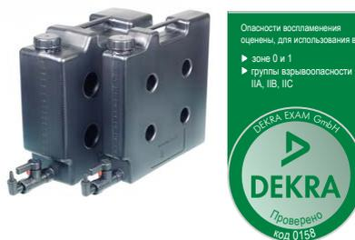
Компактная канистра из электропроводящего ПЭВП предназначена специально для использования на взрывобезопасных участках. Канистра со специфическим поверхностным сопротивлением  $<10^5$  Ом имеет высокую электропроводность. Таким образом, при правильном заземлении она позволяет избежать опасности воспламенения вследствие электростатического разряда. Тем самым, канистра соответствует требованиям директив ATEX 137, TRBS2153 и CENELEC 50404.
