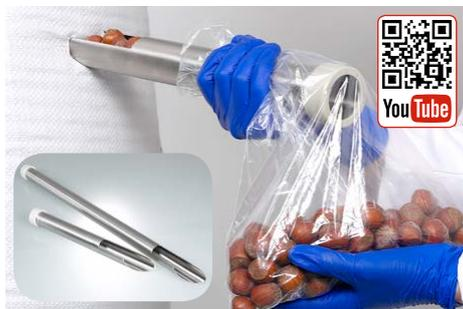
Пробоотборник простой конструкции для работы с сыпучими насыпными материалами с размером частиц примерно до 1 см. Соответствует требованиям стандарта ISTA для зерен 10 мм (пшеница, овес) и 5 мм (вика, лен).
