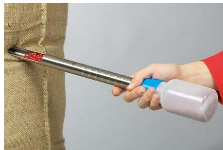
Мешочный щуп хорошо подходит, если пробоотбор насыпных материалов проводится напрямую из мешков или промышленных упаковок и сразу переносится в бутылку для образцов. Пробоотборник «КвикПикер» (QuickPicker) поставляется в комплекте с двумя бутылками для образцов из ПЭ, 250 мл, и щеткой для очистки. Соответствует требованиям стандарта ISTA для зерен 10 мм (пшеница, овес) и 5 мм (вика, лен).
