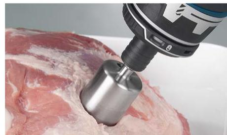
Бур для отбора проб туш животных оснащен шестигранным креплением для битодержателей или патронов для дрелей, подходящим для всех стандартных аккумуляторных шурупвертов или дрелей.
