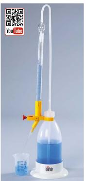
Bürette mit Schellbachstreifen nach Schilling/Bürkle mit original Bürkle-Dosierarmatur. Die Bürette ist ein universeller Helfer in Laboratorien, Galvanik, Wasseraufbereitungs-Stationen, Kläranlagen, bei Felduntersuchungen usw.
