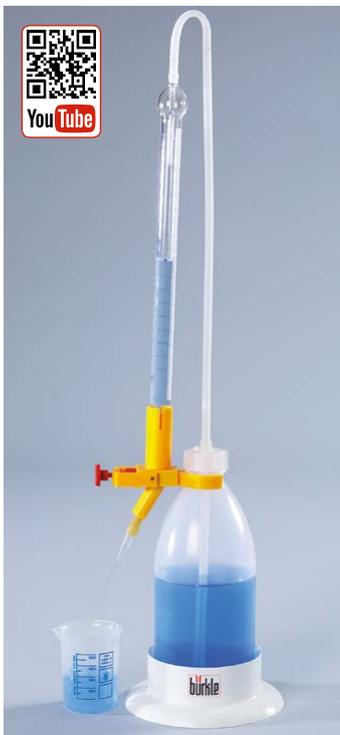
Bureta con banda Schellbach de Schilling/Bürkle con sistema de dosificación original de Bürkle. La bureta es de uso imprescindible en laboratorios, industria de galvanizados, plantas de tratamiento de aguas, instalaciones de depuración, investigación de campo, etc. Dosificación de precisión mediante un pulsador, titración exacta con microtornillo y boquilla de precisión. La graduación corresponde a la clase B (tolerancias conforme a DIN EN ISO 385).
