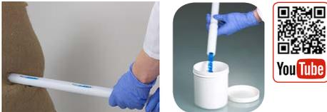
Einweg-Zonensammler für die Probenahme aus mehreren Schichten des Probengutes. Geeignet für fließfähige Pulver und feinkörnige Granulate.
