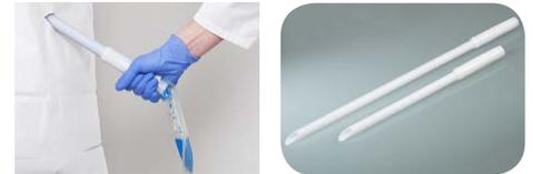
Für fließfähige Pulver und feinkörnige Granulate. Die Probe fließt über das offene Innenrohr direkt in den darunter gehaltenen Beutel.
