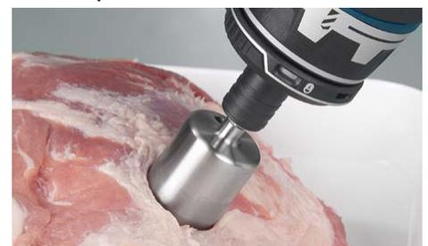
Der Bohrkopf für Schlachtkörper-Probenahmen hat eine sechseckige Aufnahme für Bithalter oder Spannfutter, passend für alle herkömmlichen Akkuschauber oder Bohrmaschinen.
