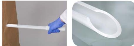
PowderDispo ist der ideale Einweg-Probennehmer für Querschnittsproben von pulvrigen oder leicht kohäsiven Substanzen.
