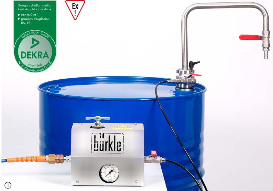
Ce système de prélèvement pour solvants permet de transvaser rapidement et aisément des liquides ultra purs. Un gaz sous pression (air comprimé ou azote) permet d'obtenir une surpression à l'intérieur du récipient, poussant le liquide vers l'extérieur. L'avantage de la commande via gaz sous pression réside dans le fait que l'utilisateur peut facilement prélever même de grandes quantités tout en ayant les deux mains libres pour transvaser le solvant.
