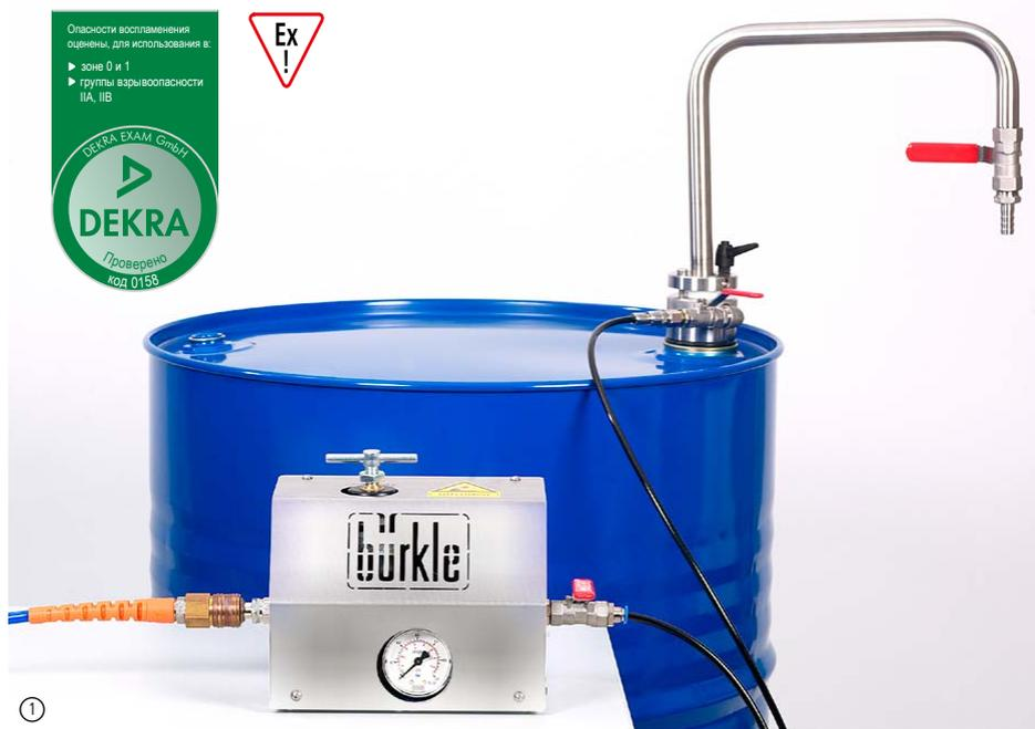
Система для отбора растворителей позволяет осуществлять быстрый и удобный розлив жидкостей высокой степени очистки. С помощью сжатого газа (сжатого воздуха или азота) в таре создаётся избыточное давление, вытесняющее жидкость из ёмкости. Преимущество использования сжатого газа состоит в том, что пользователь без труда может производить также отбор больших объёмов. При этом для розлива растворителя у него остаются свободными обе руки.
