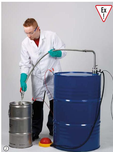
Ножной насос для работы с высокочистыми жидкостями, например, растворителями. Все части насоса, вступающие в непосредственный контакт с жидкостью, изготовлены из нержавеющей стали (1.4301) и ПТФЭ. Резьбовое соединение и запорный кран обеспечивают герметичность соединения насоса и контейнера.
