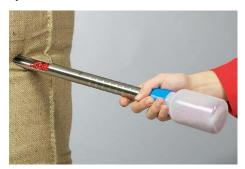
Especialmente apropiado cuando se deben tomar muestras de productos a granel directamente de sacos o bolsas y depositarlas directamente en la botella para muestras original. QuickPicker se suministra completo con dos botellas para muestras de 250 ml fabricadas en PE y un cepillo de limpieza. Conforme a la norma ISTA para una longitud de semilla de 10 mm (trigo, avena) y 5 mm (lino, veza).
