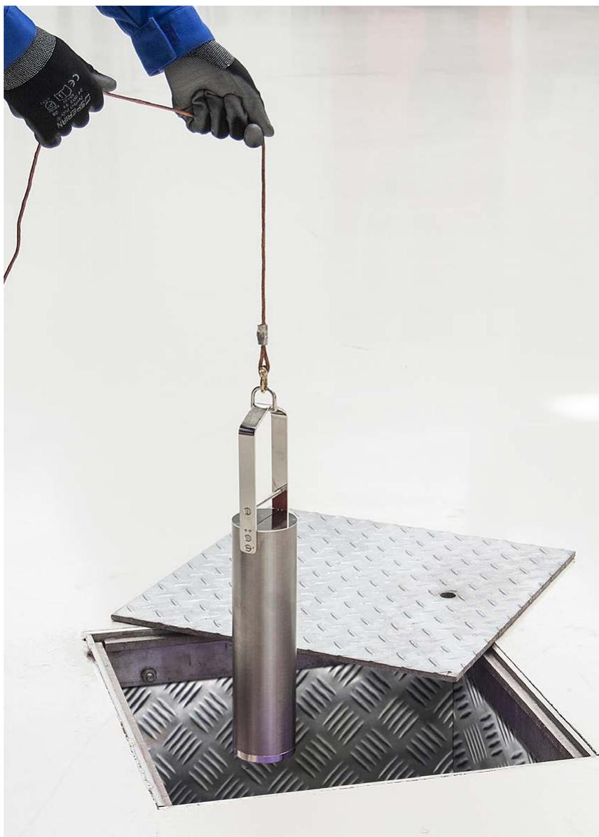
Das Absenken durch eine manuelle Seilspule ermöglicht flexible Anwendungen und eine sichere Handhabung. Die geschlossene Konstruktion der Tauchbehälter verhindert das Verschütten oder Verspritzen der gefährlichen Flüssigkeit - dies schont den Benutzer und die Umwelt.
