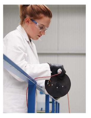
Les bouteilles de trempage sont fabriquées en laiton ou en acier inoxydable ne produisant pas d'étincelles. En combinaison avec un tambour d'enroulement conducteur d'électricité et un câble de descente approprié de Bürkle, le danger d'inflammation dû à l'accumulation de charges électrostatiques est exclu.
