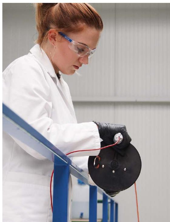
Los frascos de inmersión están fabricados de latón o acero inoxidable, materiales que no producen chispas. En combinación con un carrete fabricado con materiales eléctricamente conductivos y un cable de descenso adecuado de Bürkle se excluye el peligro de ignición por acumulación de carga electrostática.
