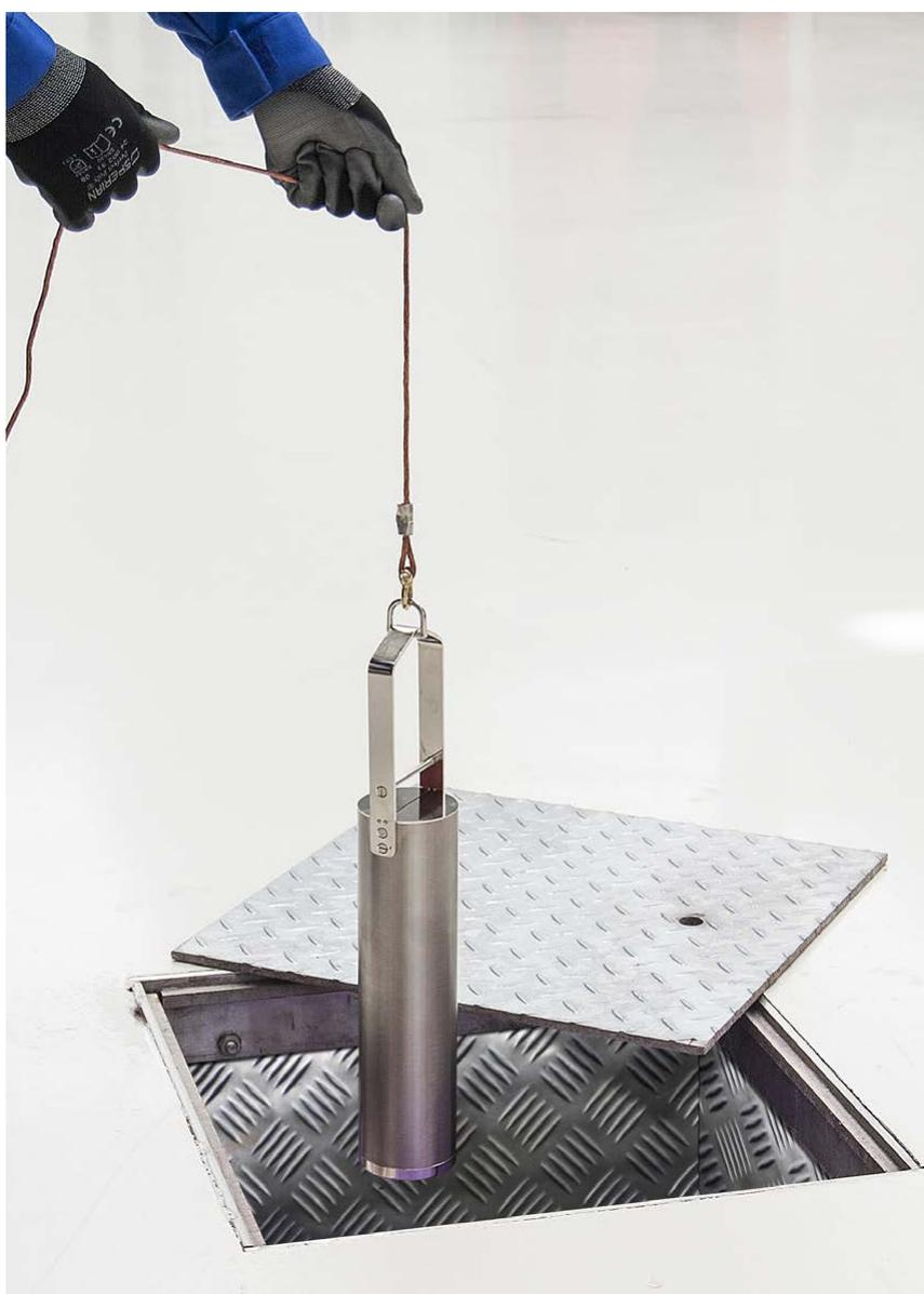
El descenso con la bobina manual permite aplicaciones flexibles y un manejo seguro. La construcción cerrada de los frascos de inmersión evita el derrame o salpicadura de los líquidos peligrosos, lo que protege al usuario y al medio ambiente.
