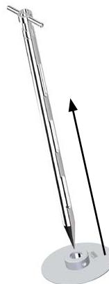
2. Positionner la butée de profondeur à la hauteur souhaitée sur l'échantillonneur.
