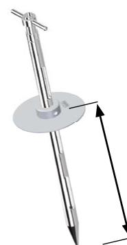
3. Mit Innensechskantschlüssel (5 mm) fixieren (nicht im Lieferumfang enthalten). Sechskantschlüssel lediglich zum Fixieren und zum Lösen verwenden, nach Einsatz wieder entfernen.
