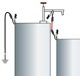
3. При использовании с неэлектропроводящей наполняемой ёмкостью подключите медный кабель без изоляции ③ к электропроводящему материалу с помощью заземляющего зажима и погрузите свободный конец в вещество для заземления.
