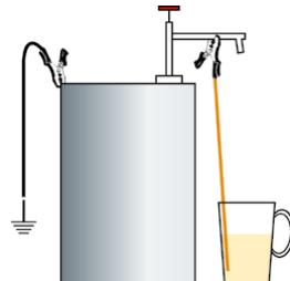
3. Lors de l'utilisation avec un récipient cible non conducteur, raccorder le câble en cuivre nu ③ au matériau conducteur à l'aide d'une pince de mise à la terre et laisser l'extrémité libre dépasser dans le fluide à mettre à la terre.
