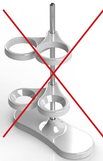
Неправильное положение держателей воронок - опасность опрокидывания!
