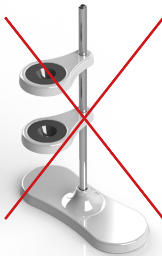
Неправильное положение держателей воронок - опасность опрокидывания!
